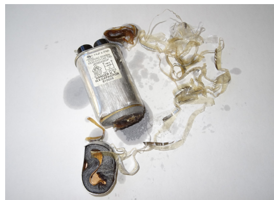
Innenleben eines Mikrowellenkondensators
