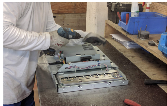
Manuelle Zerlegung eines PC-Monitors
