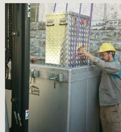
Abbildung 3: Die UN-geprüften Sammelbehälter werden mit Traggurten in die und aus den Transportbehältern gehoben
