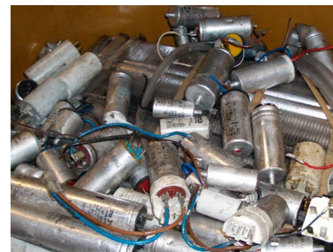
Abbildung 1: Gemischte Kondensatoren aus entsorgten Elektrogeräten
